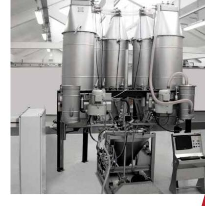
Il Sistema permette lo stoccaggio e la pesatura di grandi quantitativi di coloranti in polvere e la loro dissoluzione con distribuzione automatica nelle macchine di tintura.
